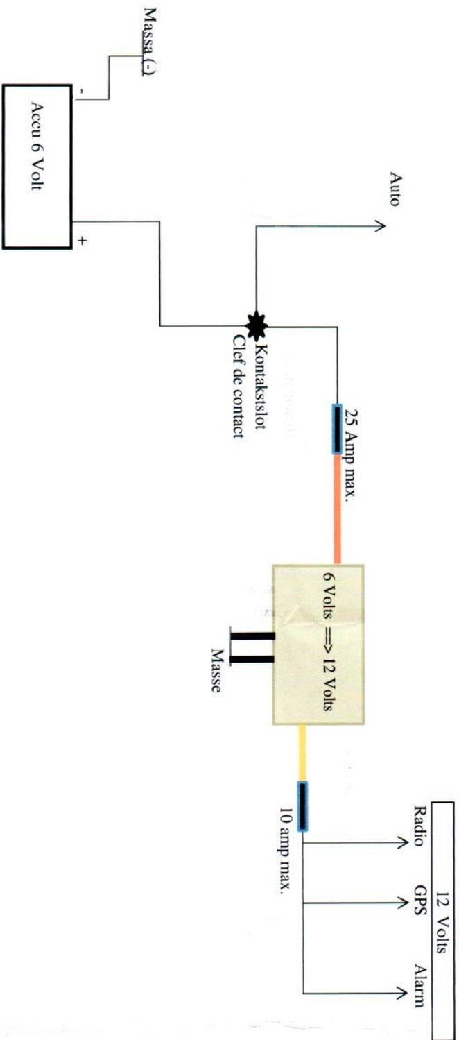
**NL :** Aansluiting van de omvormer na kontakslot omdat deze omvormer ook continu stroom verbruikt
